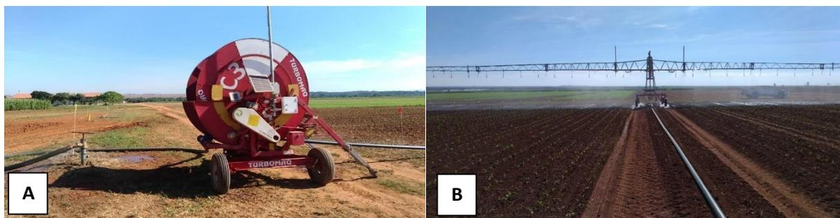
**Figura 1.** A : Carretel enrolador Autoptopelido; B: Barra irrigadora.
