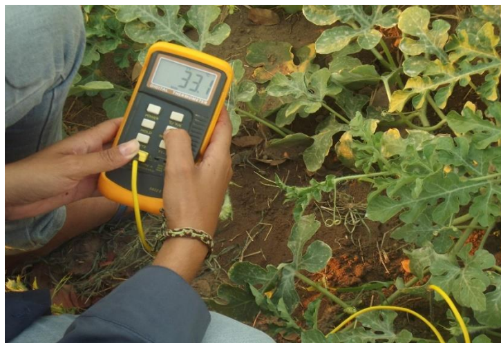
Figura 1. Leitura da temperatura do solo com uso de sensor Termopar tipo K conectado a termômetro digital (leitura realizada às 17h:28min). Bom Jesus-PI, 2015.
