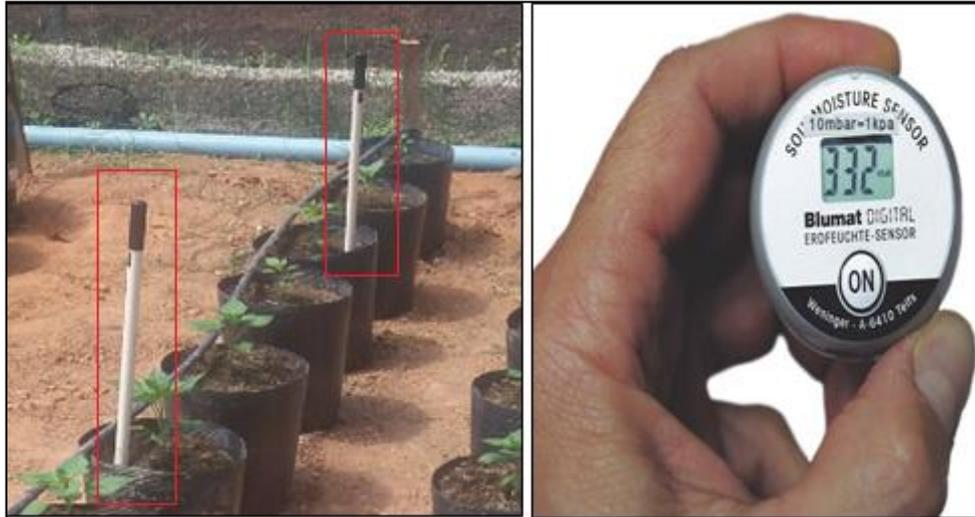
**Figura 1.** Tensiômetros de punção instalados nos vasos e tensímetro digital para fazer as leituras das tensões
