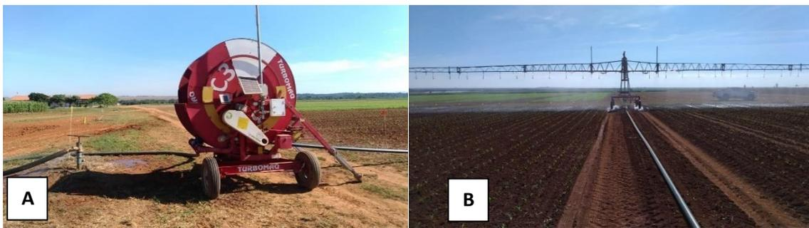
**Figura 1.** A: Carretel enrolador Autoptopelado; B: Barra irrigadora.
