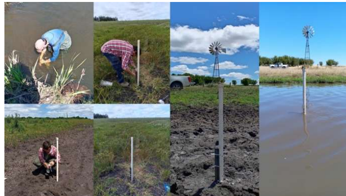
Figura 4. Instalación de sensores de CE y nivel de agua en diferentes sitios superficiales (cañadas, arroyos, canales de riego) y subterráneos (pozos para agua de ganado y doméstico). Instalación en sitio “Tala Via Taller (imagen izquierda arriba). Imagen abajo a la izquierda, e imágenes del centro instalación de sensor en canal con agua durante riego de arroz, imagen a la derecha sensor en canal y en pozo subterráneo a 100 metros para estudiar interacción entre agua superficial y subterránea influenciada por riego (imagen de canal con agua y sin agua).
