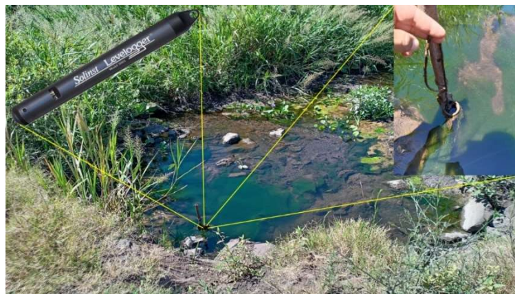
Figura 3. Sensor de CE y nivel de agua, Sitio de aforo “Tala Vía Taller”.
