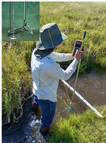
Figura 5. Medición de caudal con medidor de velocidad acústica en sitio “La Magdalena” parte alta de la cuenca, aguas arriba de la represa.
