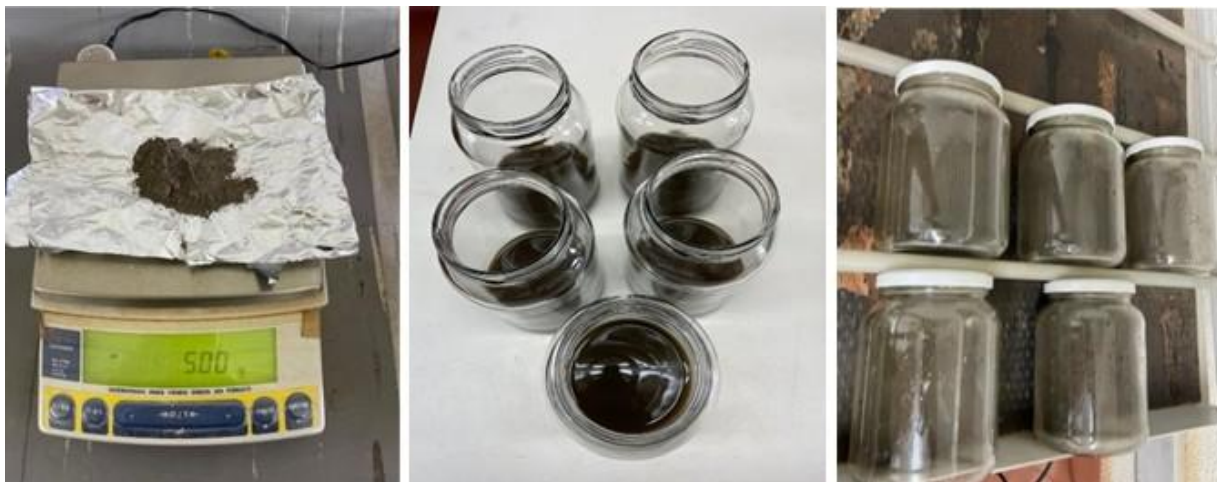
Figura 1 – Ilustração das etapas do ensaio de sorção com CBCA: (A) pesagem da massa de CBCA; (B) vinhaça + adição de CBCA; (C) agitação recíproca.
