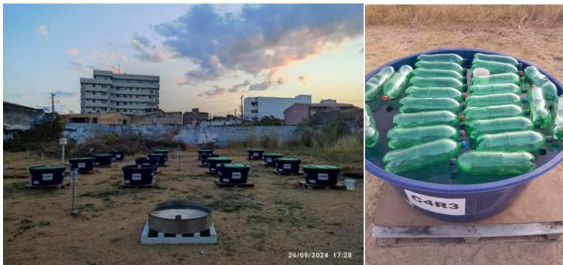
Figura 1. A esquerda vista panorâmica da área experimental; e direita detalhe da cobertura com barreira flutuante (C90%) na caixa d'água com garrafas PET, no IFCE-Campus Sobral.
