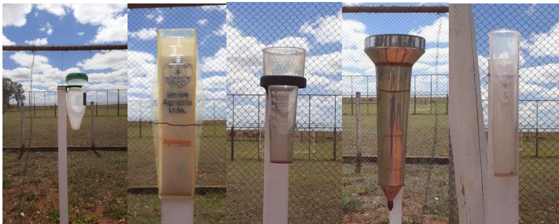
Figura 1. Pluviômetros: Ville de Paris, Pluviômetro TFA 47.1001, Pluviômetro Analógico, Pluviômetro tipo Cunha e São Izidro.
