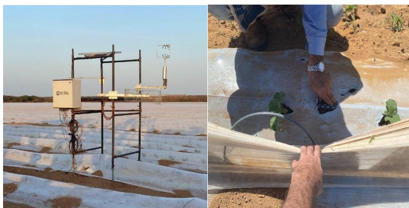
Figura 1. Instalação do experimento com visão da torre de fluxo e da cobertura com mulching e manta agrotêxtil (TNT), Icapuí-CE.
