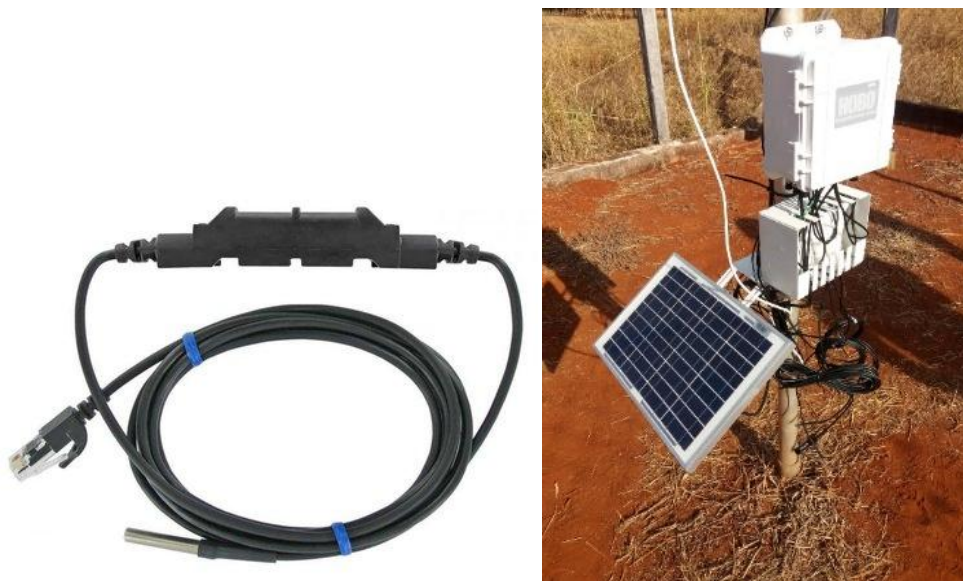
Figura 1 – Sensores de temperatura do solo conectados à estação meteorológica automática do IFTM-UDI.
