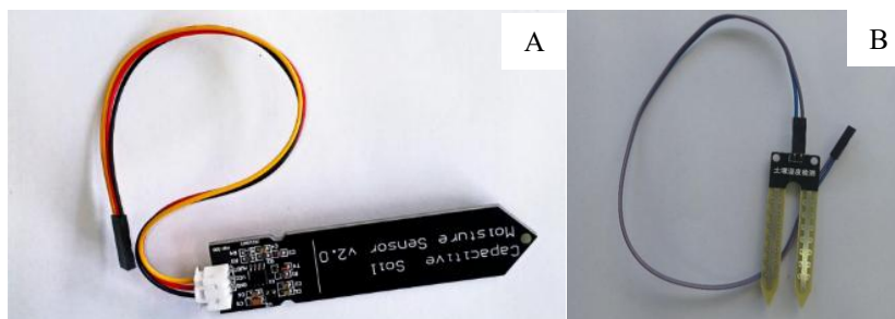
Figura 01: A sensor de umidade do solo capacitivo; B: Sensor de umidade do solo YL-69.
