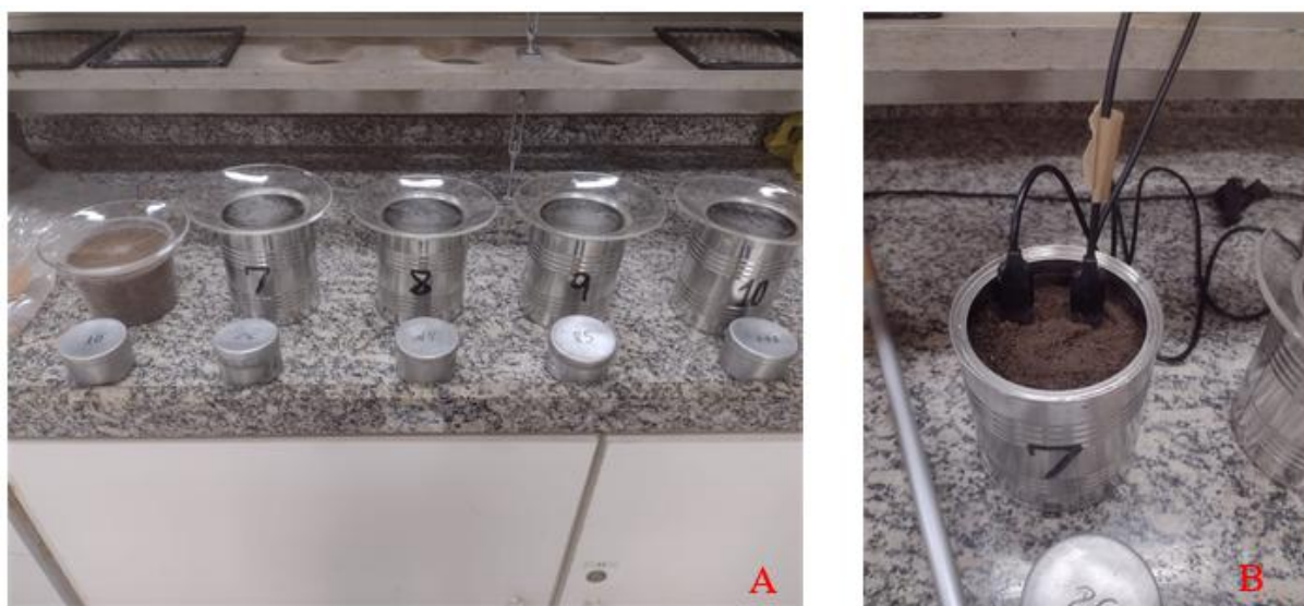
Figura 1. Disposição das amostras (A) e a forma de instalação do sensor de umidade do solo no corpo de prova com ângulo de 30° (B).
