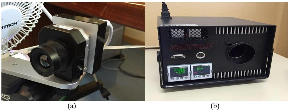
Figura 1. Cámara térmica y cuerpo negro utilizados
