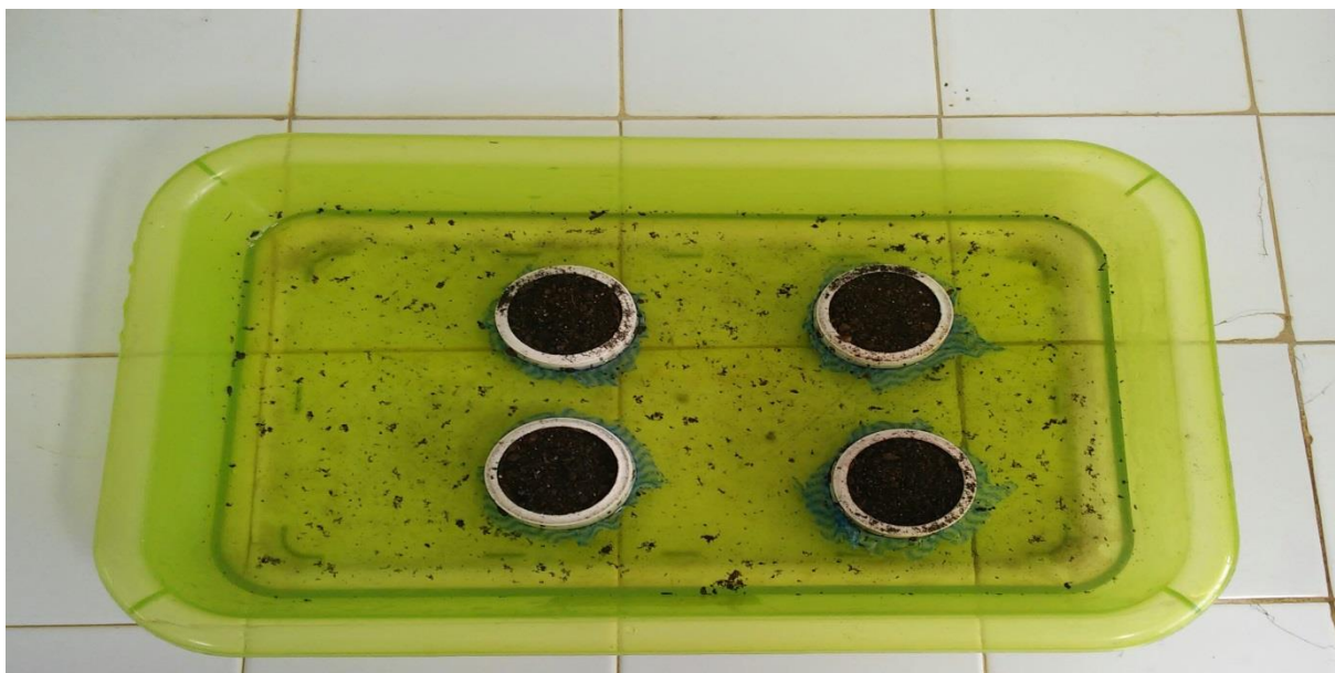
Figura 1 - Saturação das amostras no Laboratório de Hidráulica, Irrigação e Drenagem – HIDREN, UNEB - Juazeiro-BA.
