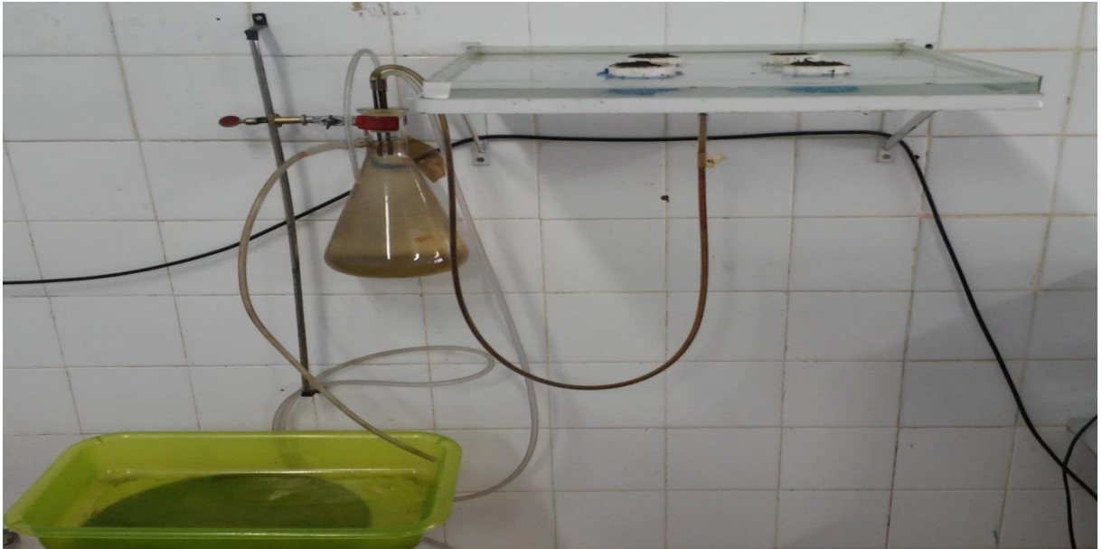
Figura 2 - Amostras na mesa de tensão, sob tensão de 10 hPa, Laboratório de Hidráulica, Irrigação e Drenagem – HIDREN, UNEB - Juazeiro-BA.
