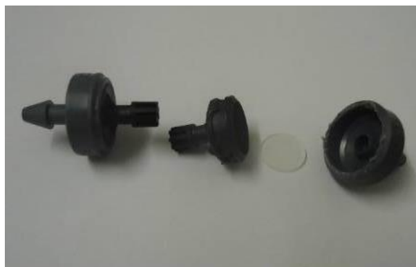
Figura 2. Imagem do gotejador, utilizado na aplicação da água residual gerada no processamento da castanha de caju.
