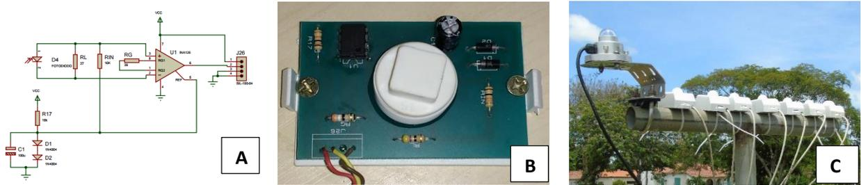
**Figura 1.** (A) Diagrama eletrônico; (B) Piranômetro montado em placa eletrônica; (C) Piranômetros posicionados para calibração.
