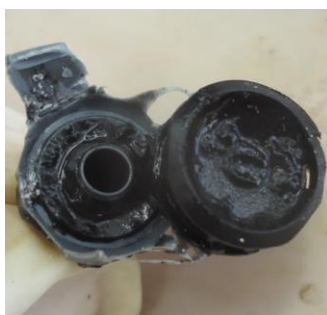
Figura 3. Gotejador com a presença de biofilme.
