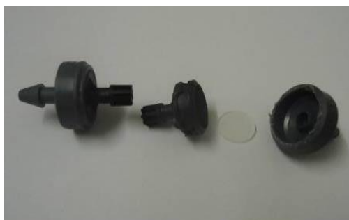
Figura 2. Imagem do gotejador, utilizado na aplicação da água residuária gerada no processamento da castanha de caju.
