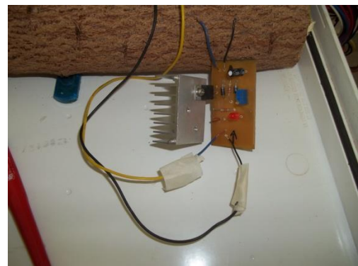
Figura 3. Esquema do circuito eletrônico do regulador ajustável de tensão contínua e foto do regulador construído em fase de teste.
