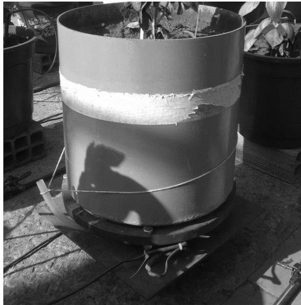
Figura 1. Lisímetro de pesagem com drenagem por mangueira
