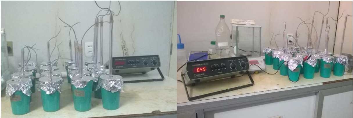
Figura 2. Calibração dos sensores: (A) detalhe da disposição dos sensores nas diferentes pastas; (B) realização da leitura com auxílio do condutivímetro de bancada
