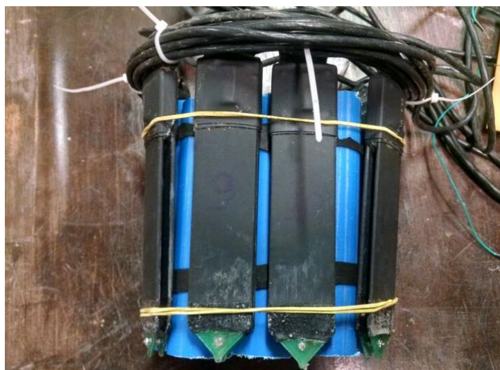
Figura 2. Sensores capacitivos de umidade do solo. Fonte: Autor
