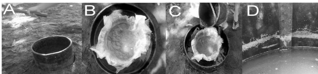
**Figura 1.** Cravação dos anéis no solo (A), ajustamento do filme plástico para evitar a infiltração da água no solo antes da realização das leituras (B), adição da água ao anel interno (C), realização das leituras (D).
