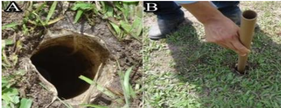
Figura 1. Abertura e tubo crivado no poço (A) e bomba sucção manual para rebaixar o nível de água no poço (B)
