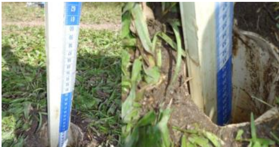
Figura 2. Régua utilizada para medição da ascensão do nível de água no poço
