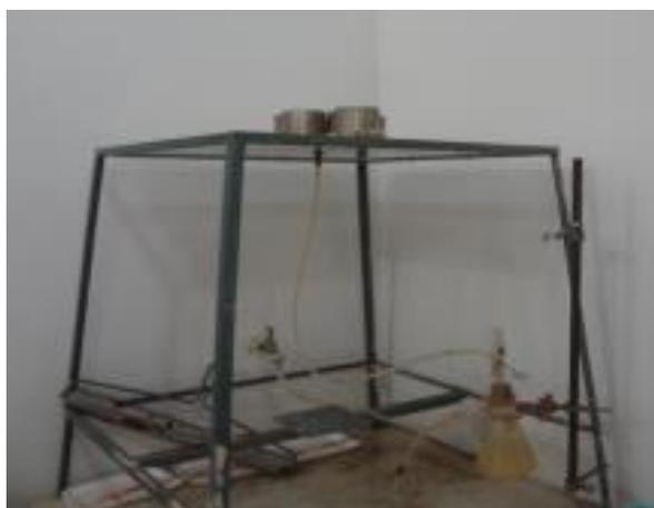
**Figura 1.** Mesa de tensão para determinação de porosidade drenável
