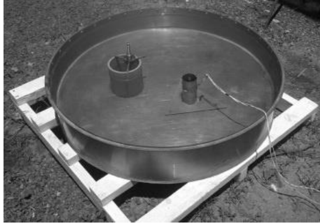
Figura 3. Sensor posicionado para leitura de nível.
