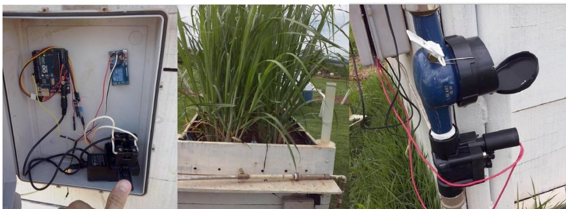
Figura 2. Esquema de ligação do sistema de automação no lisímetro de drenagem e na válvula solenoide.
